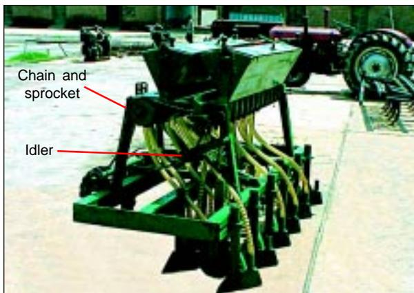
Fig. 35. Idler sprocket
